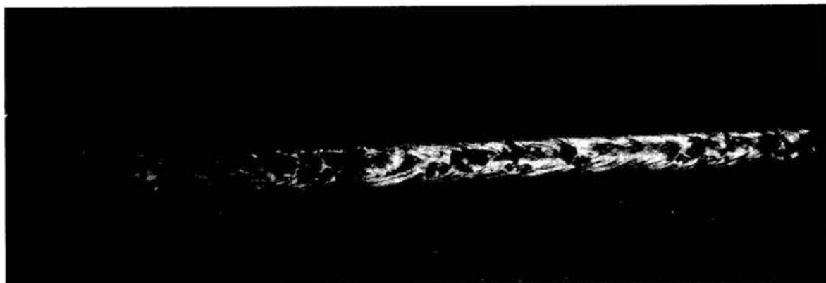
شکل ۵-۱۸ تخلخل در جوش تحت حفاظت گاز.
