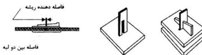
شکل ۶-۲۰ هم‌راستا نمودن ورق‌ها و حفظ هم‌راستایی در لبه‌های آنها به کمک گیره و گوه.
