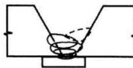
(ب) به علت فضای محدود امکان تولید حفرات هوا وجود دارد
