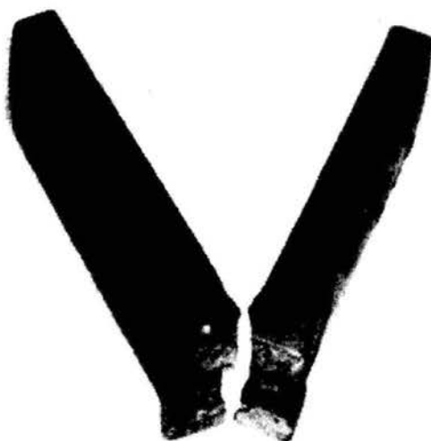
شکل ۸ - ۲۰ نمونه زخم‌دار بعد از شکست. مطالعه نشان می‌دهد جوش سالم و عاری از سرباره و اختلاط اکسید و سرباره و حفره‌های گازی بوده و میزان ذوب نیز کامل است.
