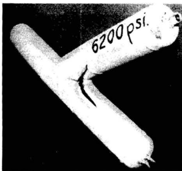
شکل ۸ - ۶۶ یک واحد لوله که تحت آزمایش نشت با فشار هیدرولیکی قرار گرفته است. جوش تحت فشاری معادل 435 \text{ kg/cm}^2 گسیخته است.
