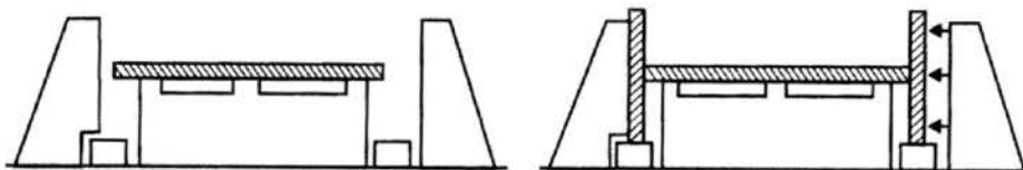
شکل ۹-۱۵ مراحل مونتاژ و جوشکاری ورق جان و بال تیوروق به روش جان قائم.
