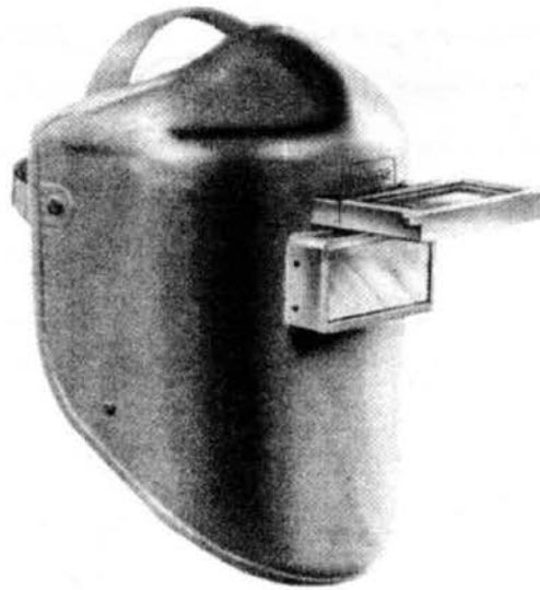
شکل ۲- ۱۹ ماسک جوشکاری با نقاب بازشو که اجازه می‌دهد جوشکار بدون درآوردن ماسک، جوش را بازرسی کرده و با برس سیمی آن را تمیز کند.
