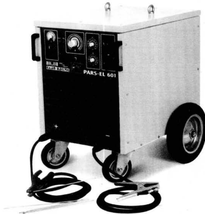
شکل ۱ - ۴ تجهیزات جوشکاری دستی شامل مولد، کابل اتصال به فلز پایه، کابل انبر، انبر و الکتروود روکش دار.
