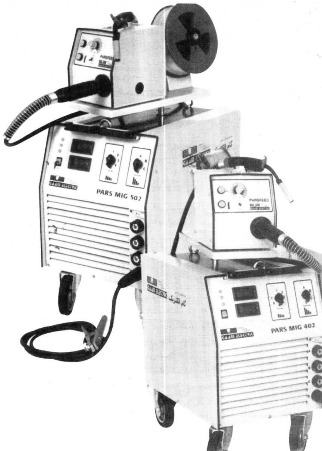
شکل ۱-۱۰ تجهیزات جوش قوس الکتریکی تحت حفاظت گاز با الکتروود مصرفی (GMAW).
