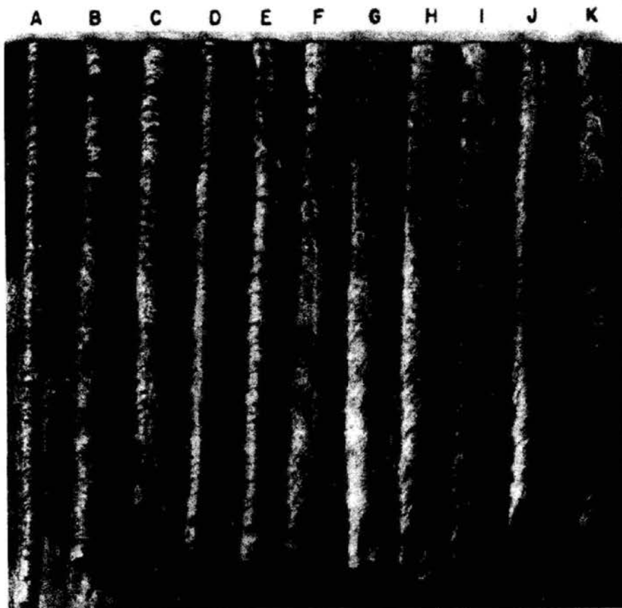
شکل ۳-۴ مقایسه ظاهر نوارجوش‌های انجام شده با انواع مختلف الکتروودها.
