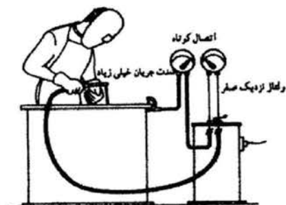
(ب) ولتاژ و آمپراژ در حالت اتصال کوتاه
