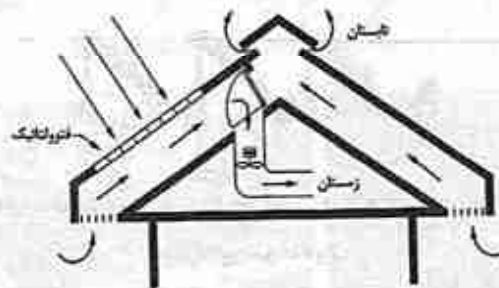
شکل ۸۶ تهویه لایه زیری مدول‌های فتوولتائیک در تابستان و استفاده از این گرما در زمستان برای گرمایش ساختمان
