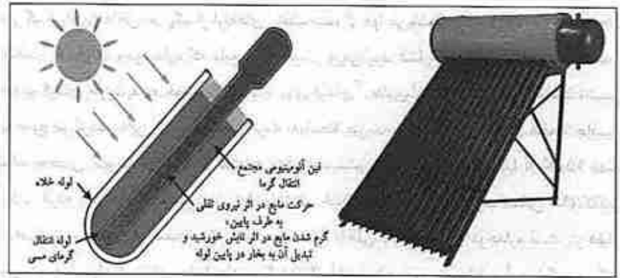
شکل ۹۷ کلکتور لوله‌ای تخلیه‌شده (خلل‌دار) - نوع تمام‌شیشه
