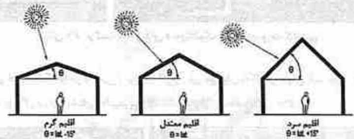
شکل ۹۱ زاویه شیب مناسب برای نصب پانل‌های فتوولتائیک
