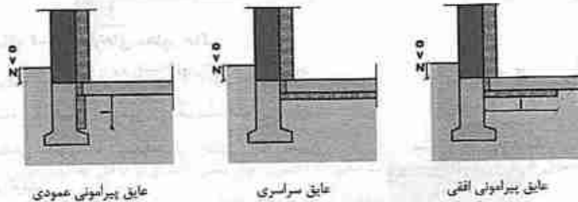
شکل ۲۸ حالات مختلف عایق کاری حرارتی کف روی خاک به صورت کاهش یافته
