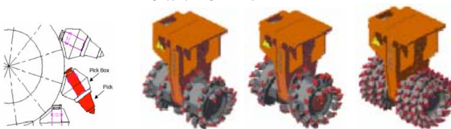
شکل ۳-۱۲-۲- نمای شماتیک کله حفاری در ماشین‌های حفار دورانی
