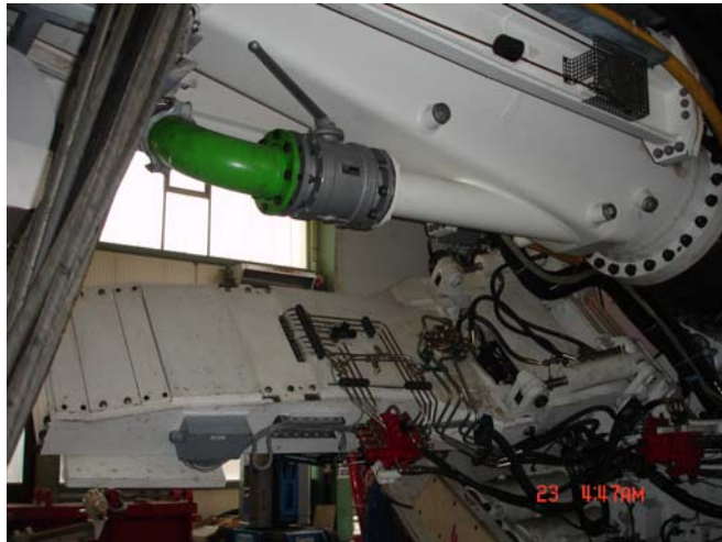
شکل ۳-۳-۲۳. بازوی جایگذاری سگمنتهای بتنی
