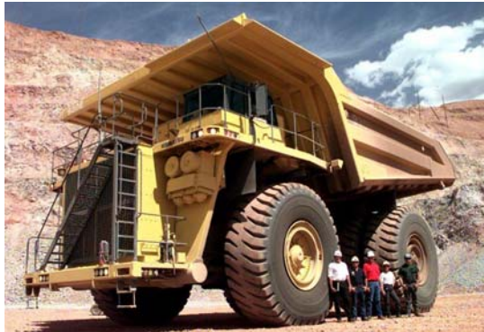
شکل شماره ۲-۷-۳- دامپتراک غیر جاده‌ای (سبک و سنگین)
