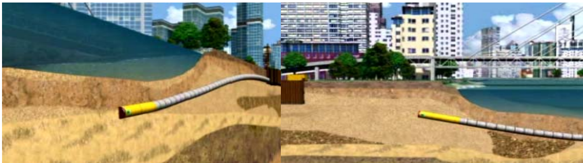
شکل ۵-۱۰-۲- نمایش مسیر لوله رانی از زیر رودخانه
