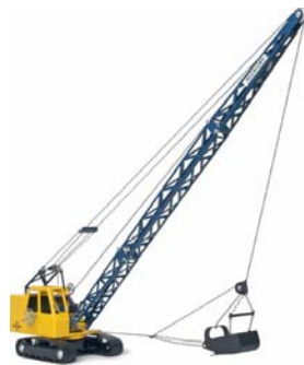
شکل شماره ۲-۱۲-۲- دراگلاین با شناسی چرخ زنجیری
