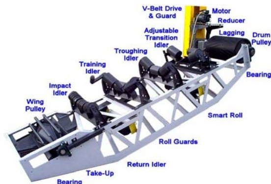
شکل ۶-۴-۴- دو نمای کلی از تجهیزات نوارنقاله
