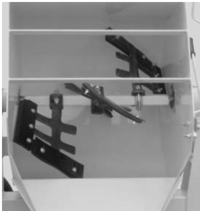
شکل ۴-۱۳-۶- یک دستگاه تولید ملات سیمان، در سمت چپ نمایی از پره‌های موجود در مخزن دیده می‌شود.
