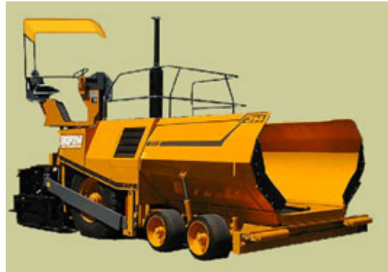
شکل شماره ۲-۱۹-۲ یک نمونه از فینیشر چرخ زنجیری (رولیک) و لاستیکی
