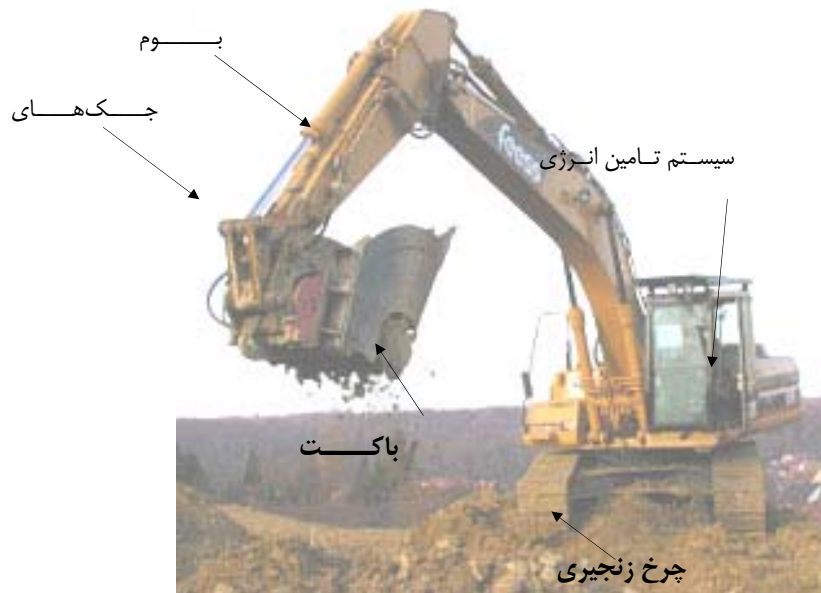
شکل ۳-۵-۷- قسمت‌های اصلی یک دستگاه باکت حفار سنگین
