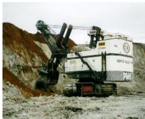
شکل ۳-۱۹-۲- شاول در حال عملیات لایه برداری
