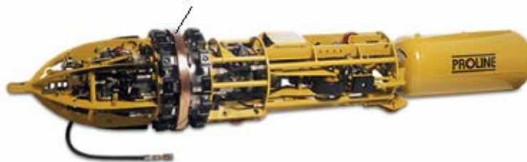
شکل ۵-۵-۴- کلمپ داخلی با صفحه کمکی مسی
