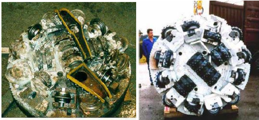
شکل ۳-۲۲-۱۱- دو نمونه از کله حفاری تمام مقطع
