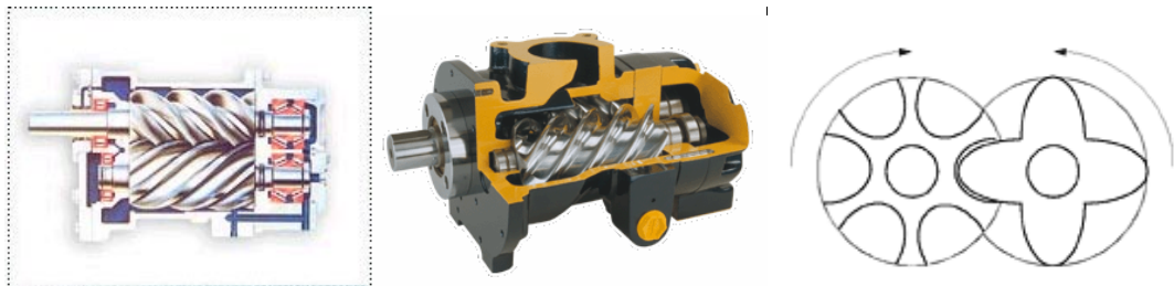
شکل ۶-۱۲-۶- نحوه عمل تراکم در کمپرسورهای دورانی پیچی (Screw)
