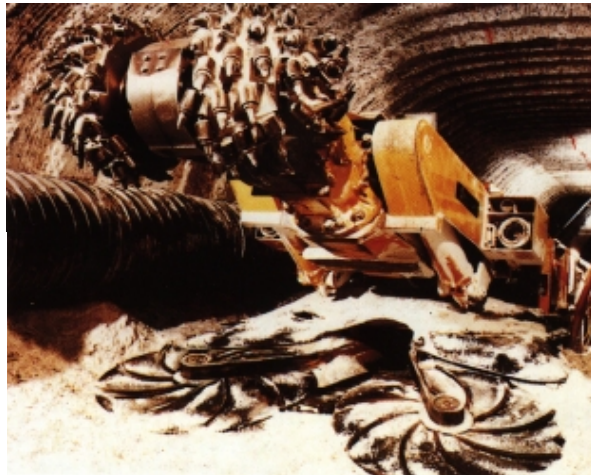
شکل ۳-۱۶-۱۵- ماشین رودهدر با دو صفحه ستاره‌دار دوار
