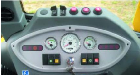
شکل شماره ۲-۹-۸- سیستم کنترل بکهو لودر جدید
