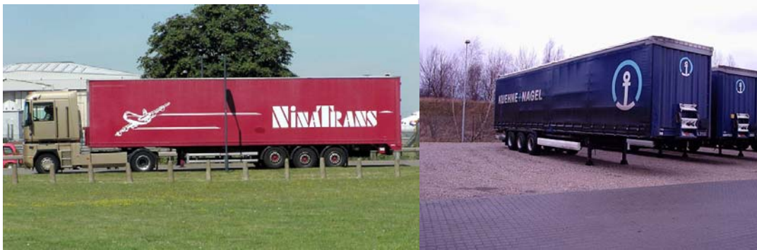
شکل ۶-۳-۶- نمایش نیمه تریلی در حالت بسته شده به کشنده و جدا
