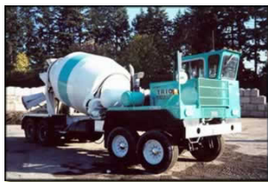
شکل شماره ۴-۹-۴- میکسرهای تخلیه از عقب بر روی شاسی‌های مختلف (تریلی، کامیونی ۴ محور، کارگاهی)
