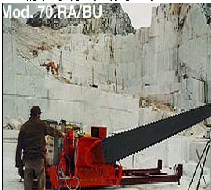
شکل ۳-۲۷-۲- نمونه ماشین هاواژ که برای استخراج سنگ ساختمانی به کار می‌رود
