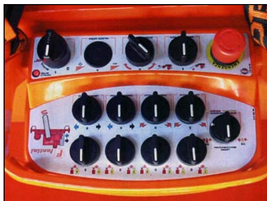
شکل ۳-۲۷-۱۲- تابلوی کنترل ماشین‌هاواژ
