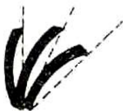
شکل شماره ۲-۵-۷- زاویای تیغه گیردر
