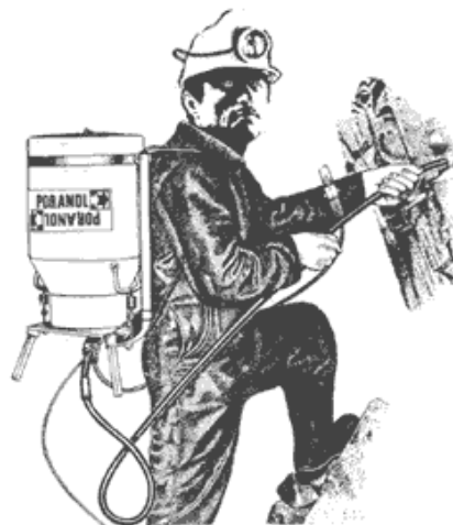
شکل ۳-۲۸-۱۲. نمونه آنفوشارژر قابل حمل به صورت انفرادی
