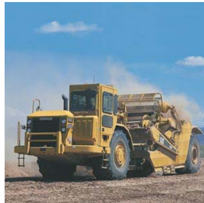
شکل ۲-۶-۹- اسکرپرهای نقاله‌دار و تعیین ظرفیت آنها
