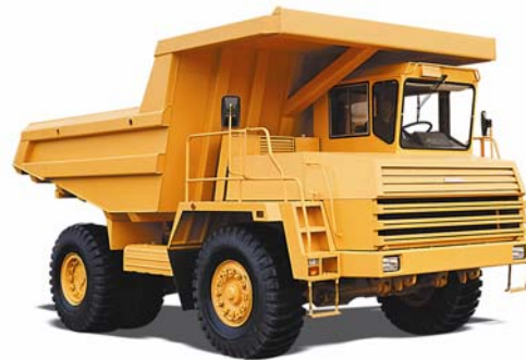
شکل شماره ۲-۷-۳- دامپتراک غیر جاده‌ای (سبک و سنگین)
