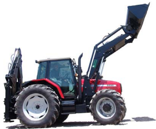
شکل شماره ۲-۹-۶- بکهو لودر کشویی هیدرولیکی
