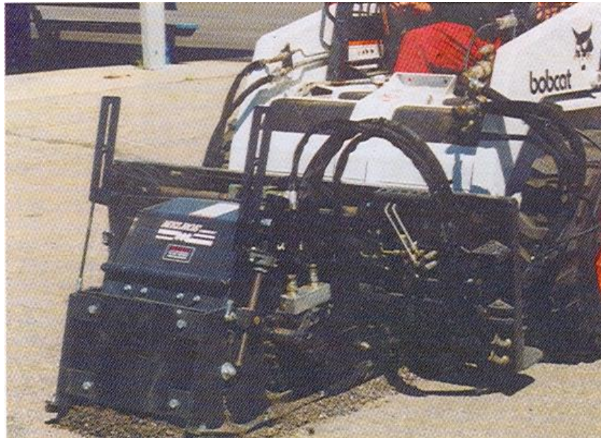
شکل ۲-۱۴-۱-۱- باب‌کت تجهیز شده برای تراش آسفالت
