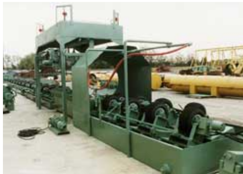
شکل ۵-۴-۹- کارگاه پوشش دهی خارجی با لعاب قیر
