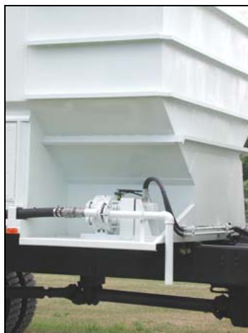
شکل ۳-۲۱-۱۳- پمپ انتقال گازوئیل
