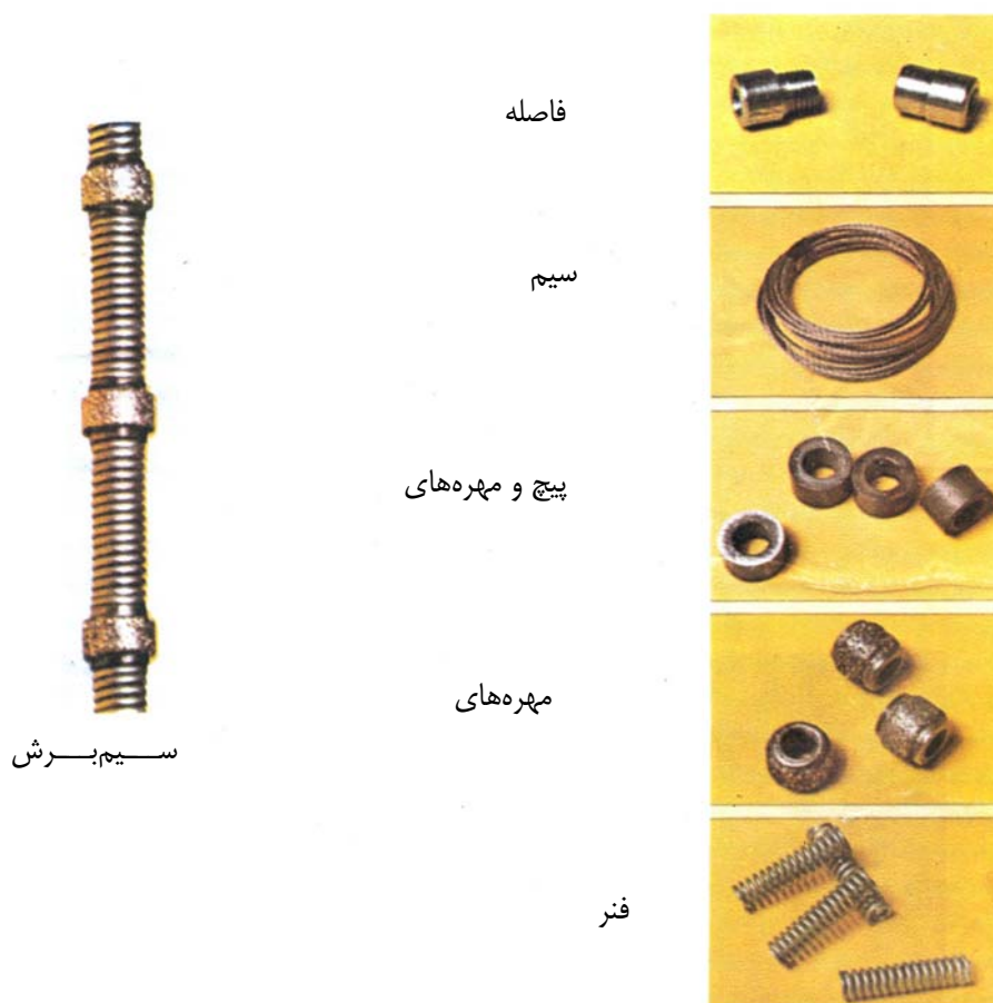
شکل ۳-۱۷-۸- قسمتهای مختلف سیم برش الماسه
