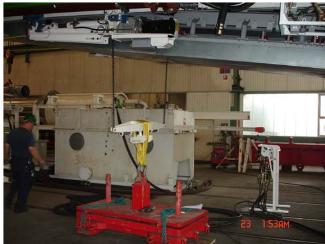
شکل ۳-۳-۲۴. جرثقیل ۲۰ تن حمل سگمنت بتنی
