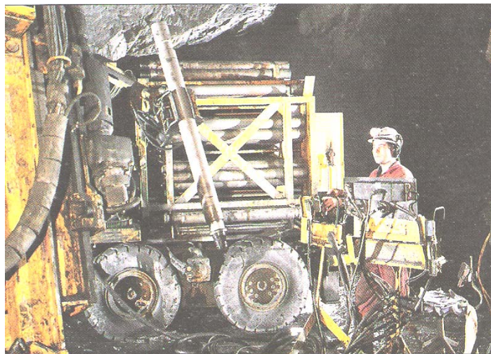
شکل ۳-۱۸-۵- نمایش سیستم جایجایی اتوماتیک لوله‌های حفاری
