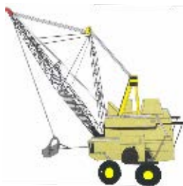
شکل شماره ۳-۱۲-۲- دراگلاین با شناسی چرخ لاستیکی
