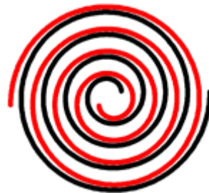
شکل ۶-۱۲-۷- نحوه عمل تراکم در کمپرسور Scroll
