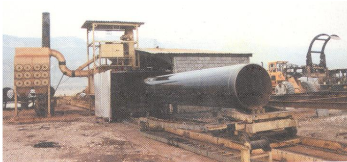
شکل ۵-۴-۵- دستگاه رنگ کاری اتوماتیک (فرایند های سند بلاست و پاشش قیر)
