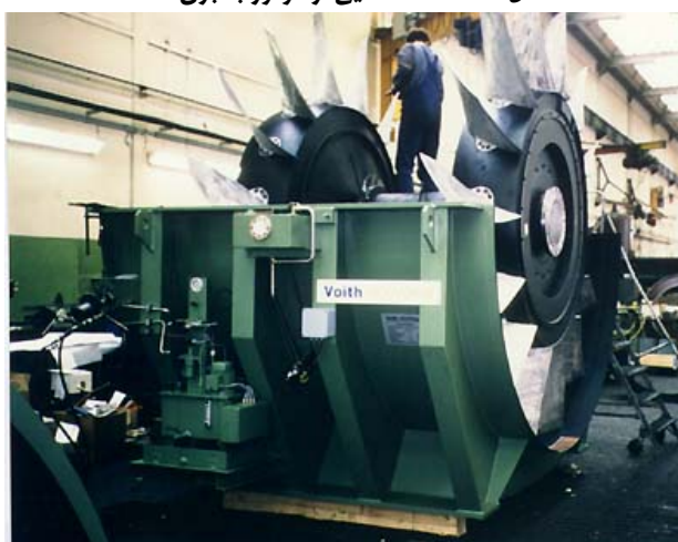
شکل ۶-۱۴-۶- بادبزن محوری دو طبقه در معدن زغال در آلمان، قطر پره ها ۳۲۰۰ میلی متر، قدرت موتور ۱۳۰۰ کیلو وات
