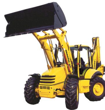
شکل شماره ۹-۲-۱- یک نمونه از بکهولودر
