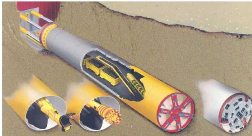
شکل ۵-۱۰-۶- انواع روش های حفاری مکانیکی
