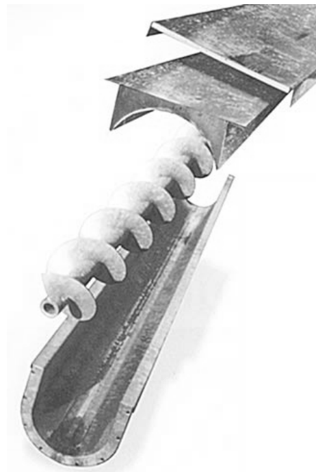
شکل ۴-۶-۶- اجزای سیستم حلزونی مارپیچی برای انتقال یخ
