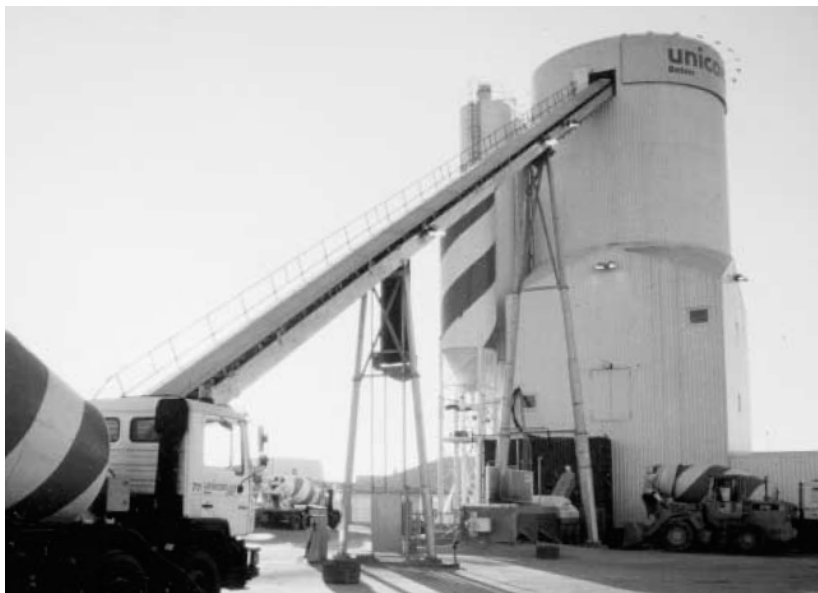
شکل ۴-۴-۲- تسمه نقاله بزرگ برای تغذیه بچینگ
