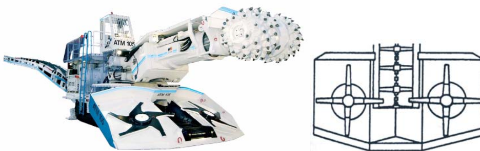
شکل ۳-۱۶-۱۴- ماشین رودهدر با صفحه پره دوار
