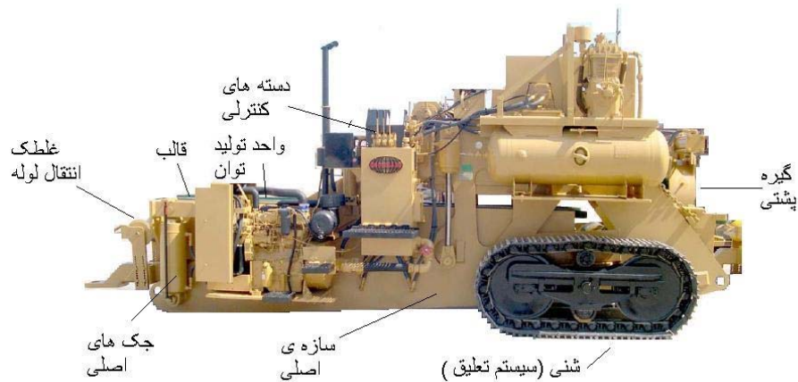
شکل ۴- اجزای اصلی یک دستگاه لوله خم کن
