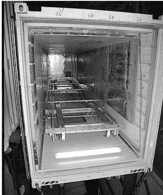
شکل ۴-۶-۳- مخزن ذخیره یخ
