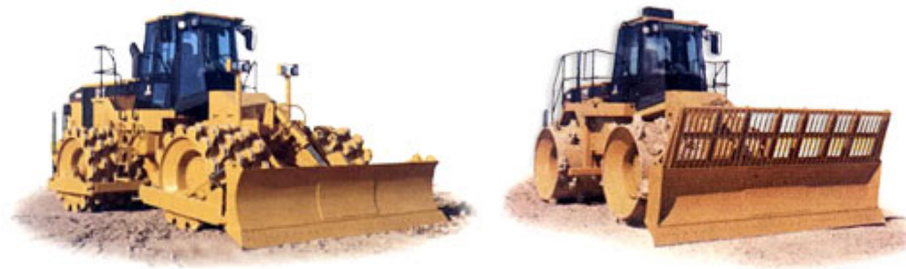
شکل ۲-۴-۱۰ و ۲-۴-۱۱- انواع تراکم کننده های شبه بلدوزر
