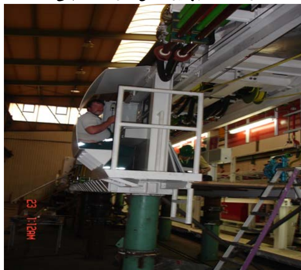
شکل ۳-۳-۲۵. کابین کنترل دستگاه واقع در یک آپ دستگاه. لازم به ذکر است اپراتور در این قسمت صرفاً کنترل حرکت دستگاه و کاتر را بر عهده دارد و به دلایل ایمنی و عدم دید کافی کنترل بخش سگمنت گذاری به صورت دستی و از نزدیکی بازوی مربوطه انجام می‌شود.
