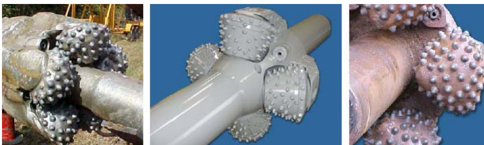
شکل ۳-۲۹-۶- چند نمونه از تعریض کننده‌های چال راهنما
