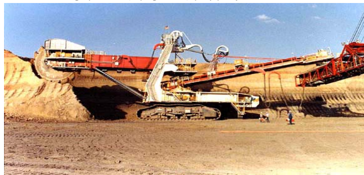
شکل ۳-۳۰-۱۰- اکسکویاتور با ظرفیت ۵۰۰۰ متر مکعب در ساعت، مکان: Monticello آمریکا
