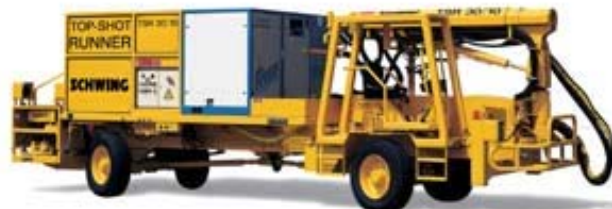
شکل ۴-۱۰-۵- پمپ بتن خود متحرک سوار بر شاسی کامیون
