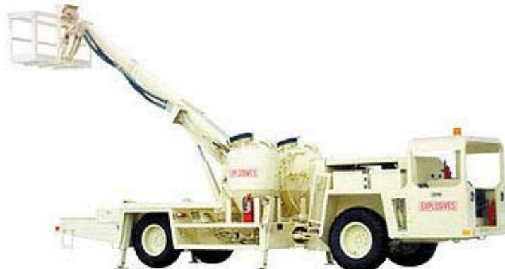
شکل ۳-۲۸-۱۰. نمونه دستگاه انفوشارژر، دارای سیستم محرکه، دکل و سبد
