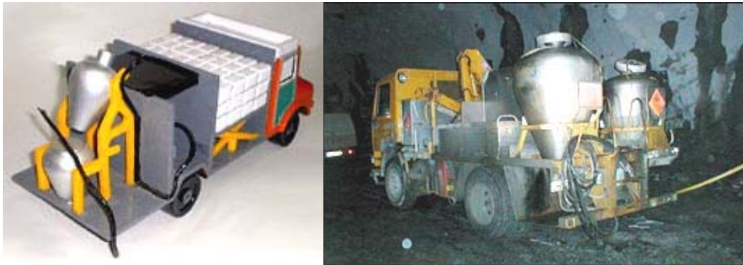
شکل ۳-۲۸-۸. نمونه دستگاه انفوشارژر، نصب شده روی کامیون
