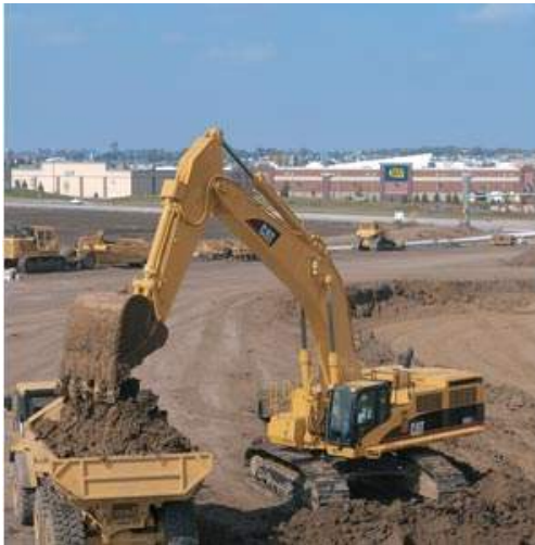
شکل ۲-۱۰-۲- بیل مکانیکی چرخ زنجیری و لاستیکی
