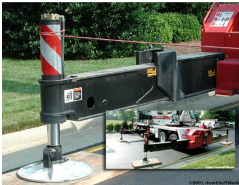
شکل ۶-۷-۷- جک (Outtrigger) در جرثقیلهای چرخ لاستیکی
