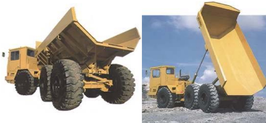
شکل ۲-۷-۵- کامیون کمرشکن در حال تخلیه
