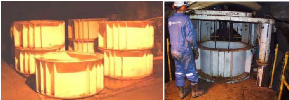
شکل ۳-۲۲-۱۴- نمایی از کیسینگ‌های استاندارد به طول ۸۰ سانتیمتر
