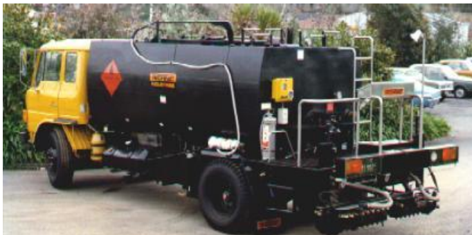
شکل شماره ۲-۲۰-۴- ماشین قیرپاش همراه تریلی
