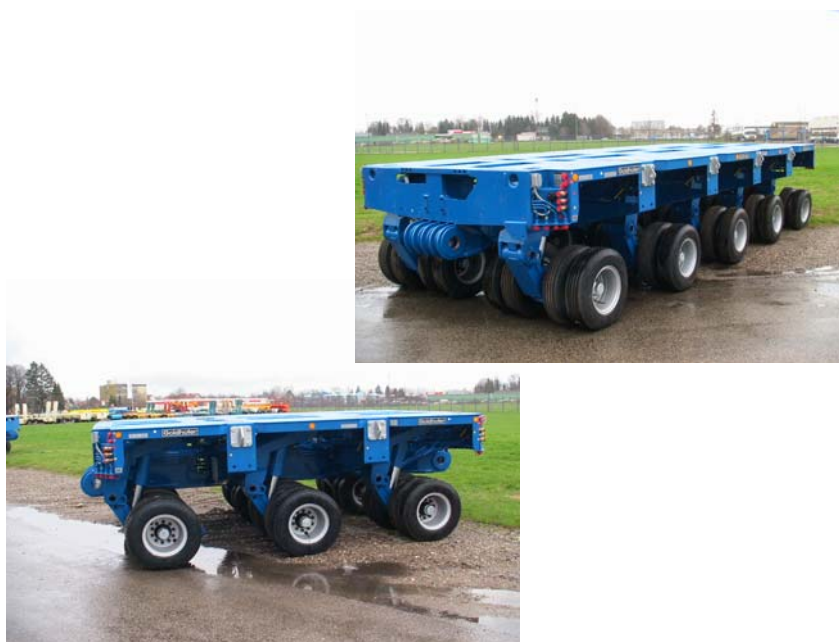
شکل ۶-۲-۶- مدول (واحدهای) تشکیل دهنده بوژی می توانند از دو تا ده محور داشته باشند.
