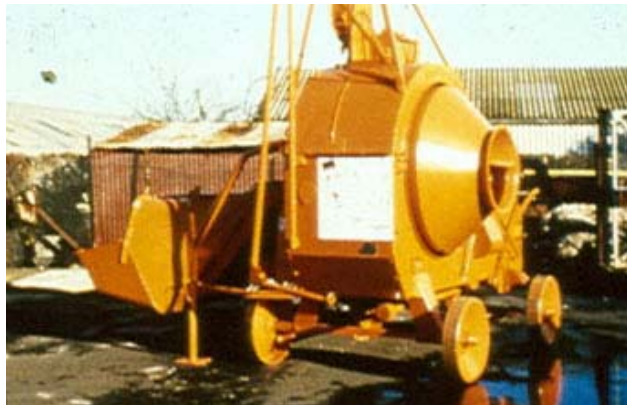
شکل ۳ یک نمونه مخلوط‌کن غیر کج شونده
