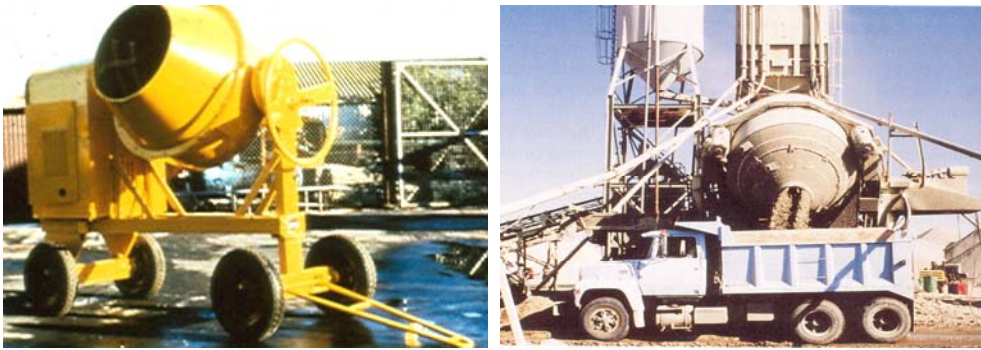
شکل ۲ انواع مخلوط‌کن‌های کج شونده
