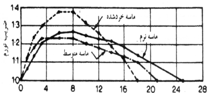
شکل ۲ اثر رطوبت ماسه بر حجم آن (به عنوان مثال)
